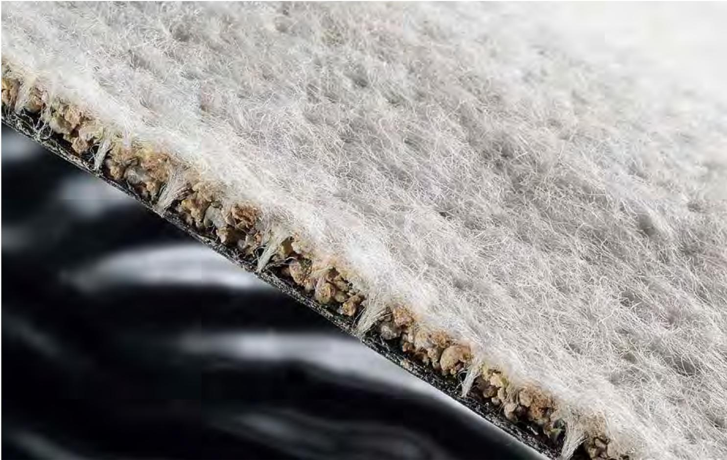
BENTOMAT GDA ist die perfekte Lösung bei höherem Wasseranstau, da bei höheren hydraulischen Gradienten der Durchfluss von geosynthetischen Tondichtungsbahnen zunimmt. Durch die Kombination mit einer PE-Membran wird dieser Effekt maßgeblich verhindert, ohne dass auf die Vorteile einer Bentonitmatte verzichtet werden muss.
