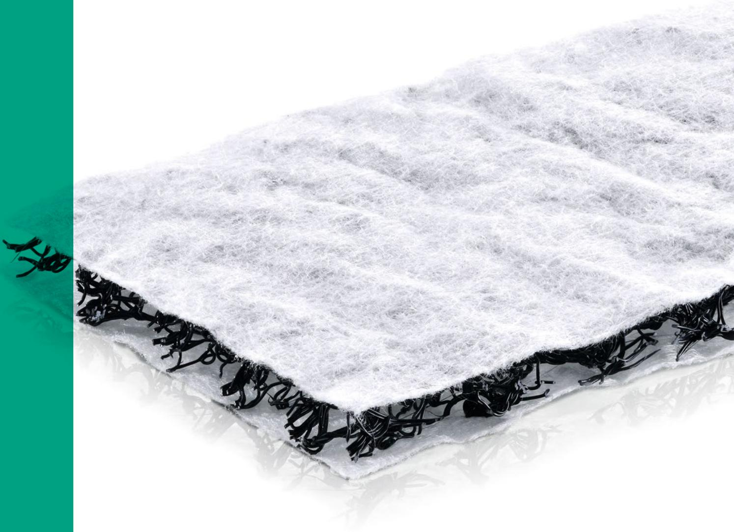
Eine wesentliche Aufgabe von Drainagematten ist das Sammeln und Abführen von anfallendem Grund-, Schichten- und Sickerwasser im Erdbau und an Bauwerken. Das Ziel ist es, erdberührte Bauwerke und Abdichtungssysteme dauerhaft vor schädigenden Einflüssen durch drückendes Wasser und Durchfeuchtung zu schützen.
