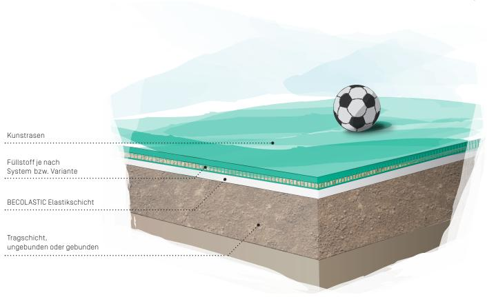
Kunstrasensystem auf DIN-gerechter, gebundener oder ungebundener Tragschicht: Diese seit 1983 bewährte Bauweise ermöglicht Bauherren die Realisierung eines Sportplatzes nach höchsten internationalen Anforderungen mit vergleichsweise niedrigen Kosten.
