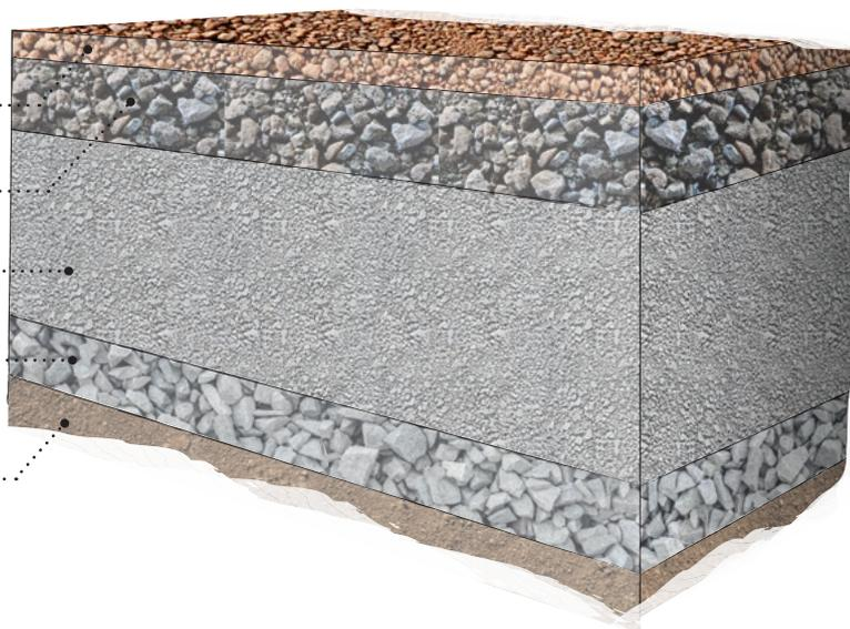
BECODYN Lava zeichnet sich durch eine hohe Wasserspeicherkapazität und sehr gute Wasserdurchlässigkeit aus. Sie ist zudem verschleiß- und witterungsbeständig und unterliegt laufenden Kontroll- und Eignungsprüfungen gemäß DIN 18035 Teil 5.
