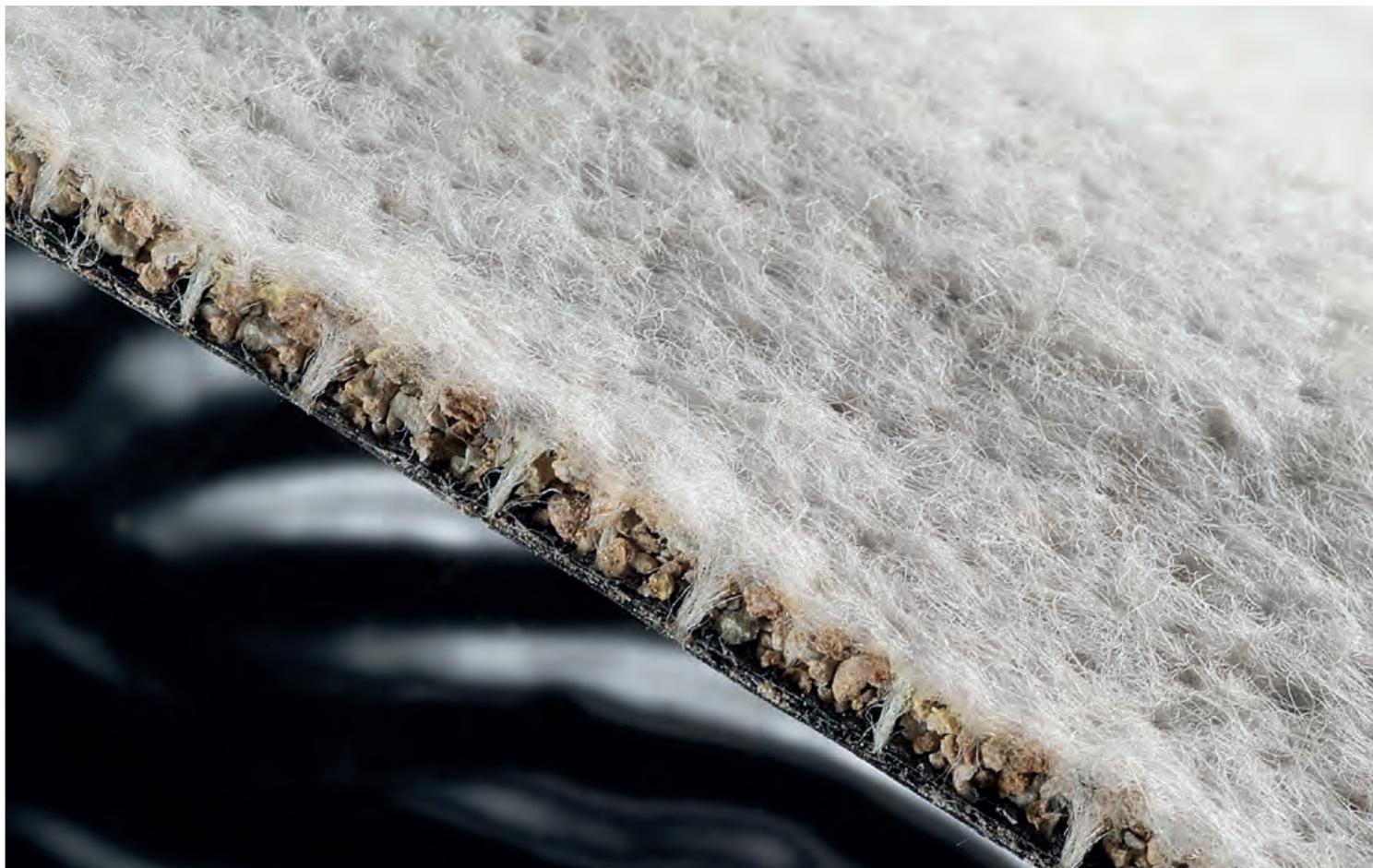
BENTOMAT GDA CL ist die perfekte Lösung bei höherem Wasseranstau, da bei höheren hydraulischen Gradienten der Durchfluss von geosynthetischen Tondichtungsbahnen zunimmt. Durch die Kombination mit einer PE-Membran wird dieser Effekt maßgeblich verhindert, ohne dass auf die Vorteile einer Bentonitmatte verzichtet werden muss.
